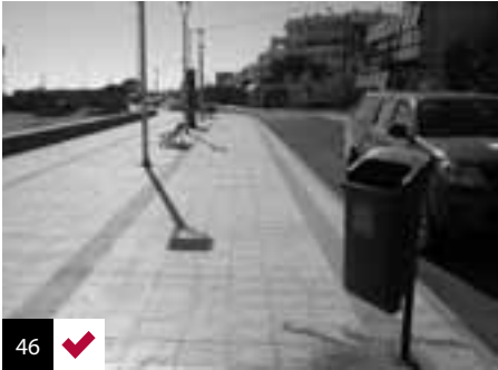
Foto 46: basurero de altura y ubicación correcta a un costado de la franja de circulación. Bahía Inglesa, Chile.
