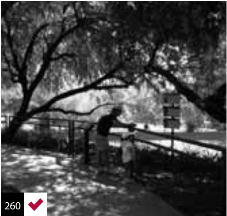
Foto 260: circuito accesible en Zoológico. Las alturas de las barandas permiten la visión de un adulto y de un niño. Phoenix, EE.UU.
