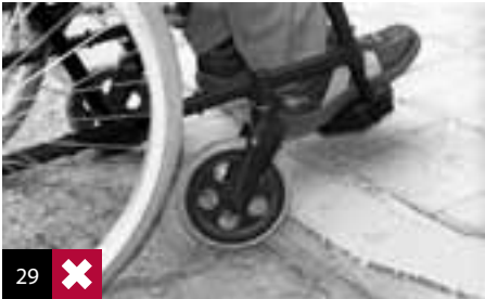
Foto 29: rebaje no practicable, mal diseño por diferencias de nivel entre vereda y calzada.
