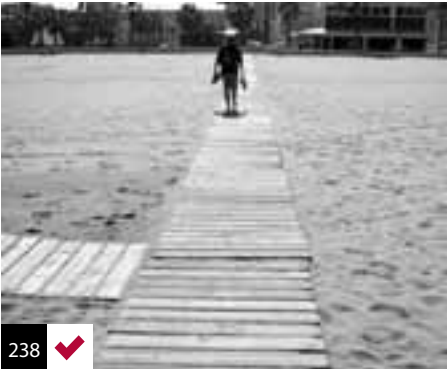
Foto 238: pasarela de madera que permite acercarse al agua y a servicios en la playa con un coche de niños o en silla de ruedas. España.
