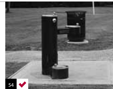
Foto 54: fuente de agua que se adapta a todas las alturas de uso (de pie, sentado y para animales). Ubicada fuera del recorrido peatonal pero con acceso a nivel. Houston, EE.UU.
